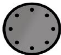
الف - مقطع ستون CFT در حالت دو لایه (حالت A) -CFDST ب - مقطع ستون CFT در حالت تک لایه تقویت شده با آماتور CFST-(B) (حالت B)
