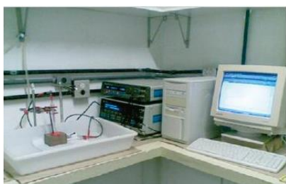
شکل ۹- تجهیزات و نمونه بکارگیری روش طیف سنجی مقاومت ظاهری
