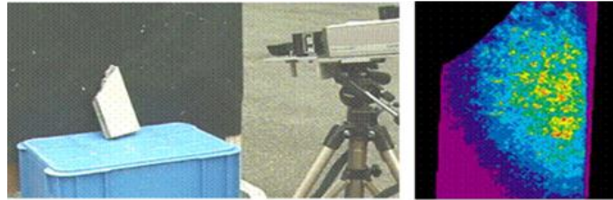
شکل ۱۲- نتیجه اندازه گیری با دوربین چند طیفی [۱۲]
