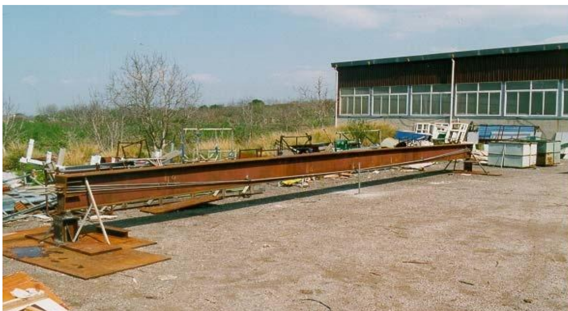
شکل ۹ - پیش تنیدگی بواسطه کابلهای آویزان
