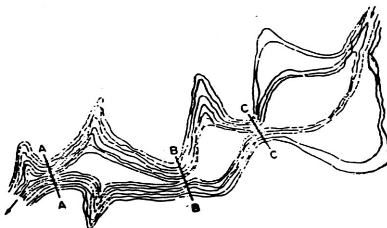
شکل ۲-۹- اثر توپوگرافی در انتخاب محل مناسب برای احداث سد
