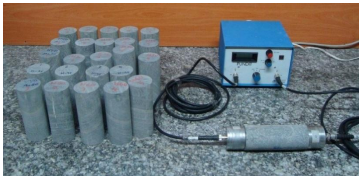
شکل ۲-۲- دستگاه و نحوه انجام آزمایش تعیین سرعت سیر موج در سنگ
