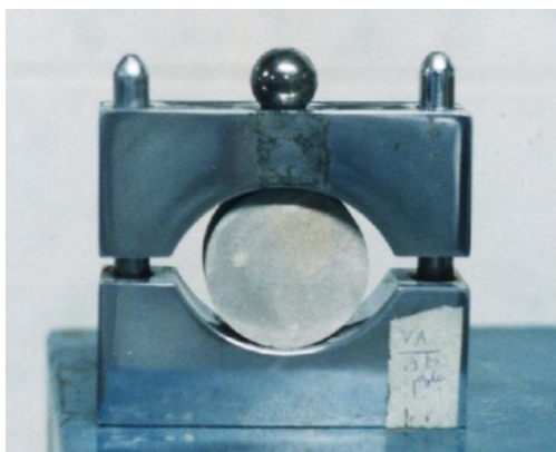
شکل ۲-۱۸- فک‌های دستگاه آزمایش تعیین مقاومت کششی به روش برزیلی
