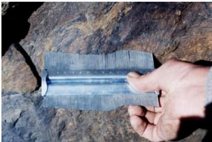
شکل ۳-۱- وسیله اندازه‌گیری زبری سطح درزه
