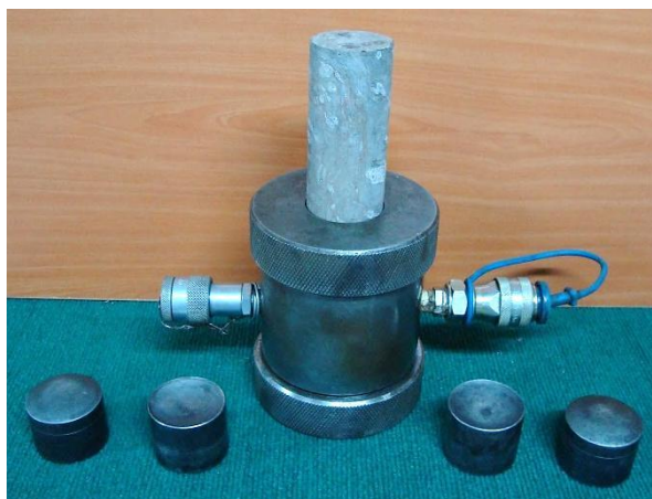
شکل ۲-۱۶- نحوه جایگذاری نمونه استوانه‌ای سنگ در سلول هوک
