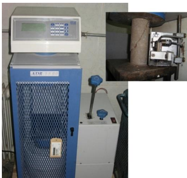
شکل ۲-۶- نمونه‌ای از دستگاه آزمایش مقاومت فشاری تک‌محوری و نحوه انجام آزمایش
