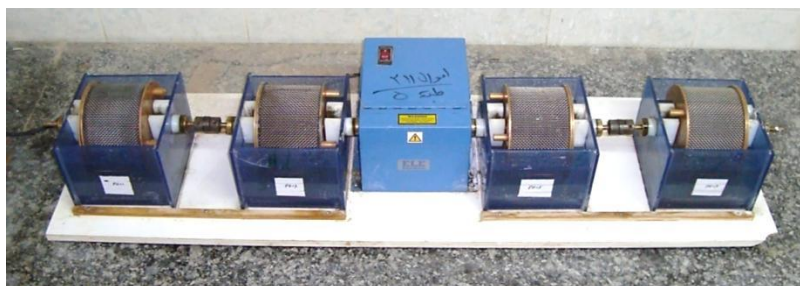
شکل ۲-۳- دستگاه آزمایش دوام- وارفنگی سنگ
