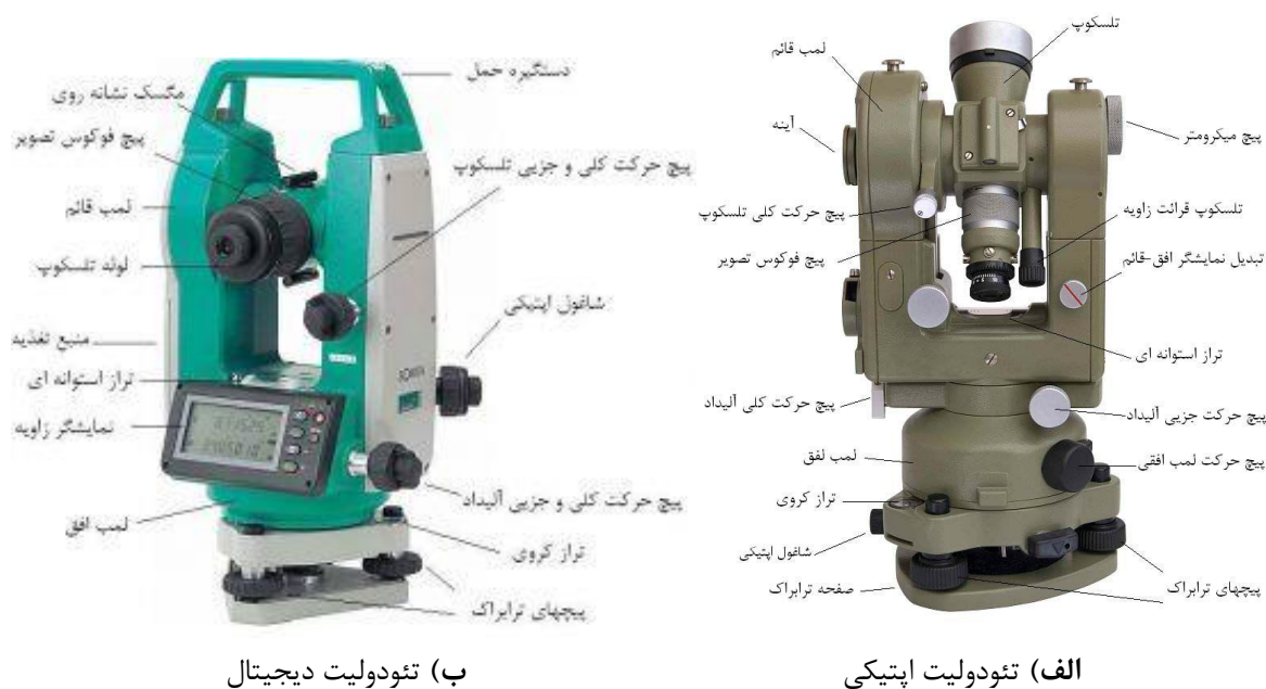
شکل ۵-۲- ساختمان دو نوع زاویه یاب تئودولیت
