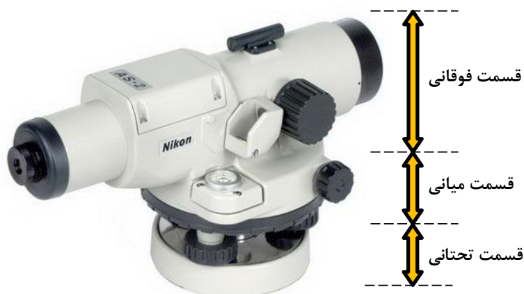
شکل ۴-۱- ساختمان دوربین نیوو
